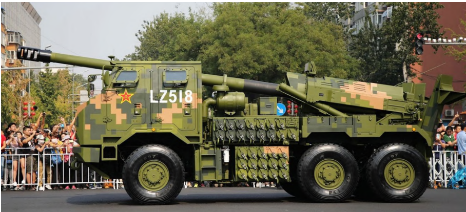
Obús autopropulsado con ruedas PCL-181 de 155 mm.
