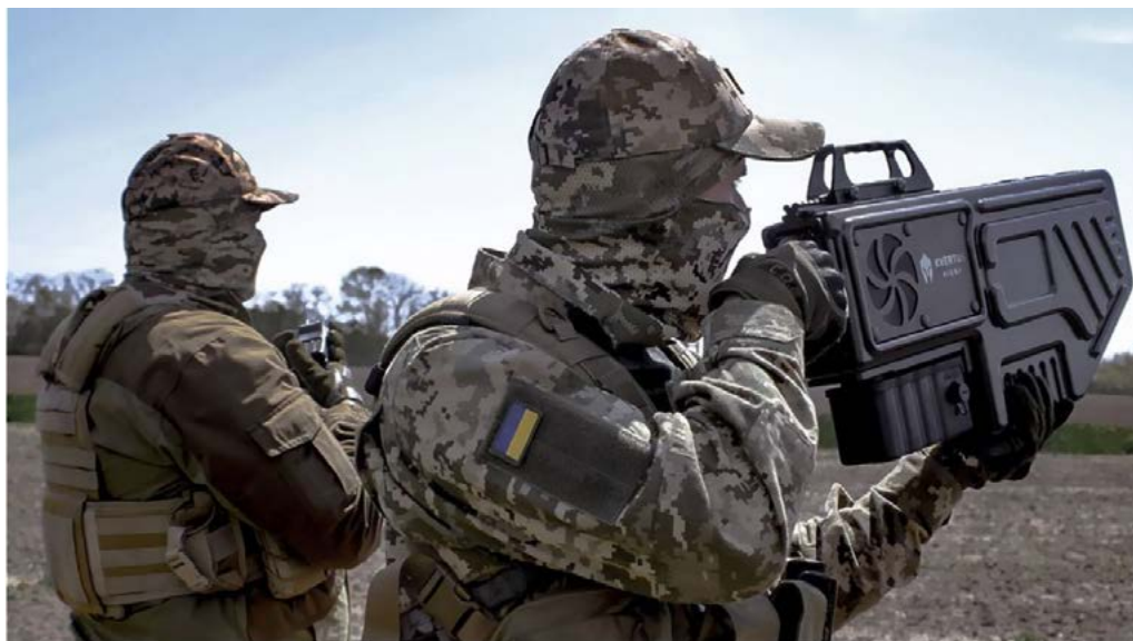
Imagen N° 6: El rifle KVSG-6 es capaz de neutralizar drones situados a una distancia de hasta tres kilómetros.
