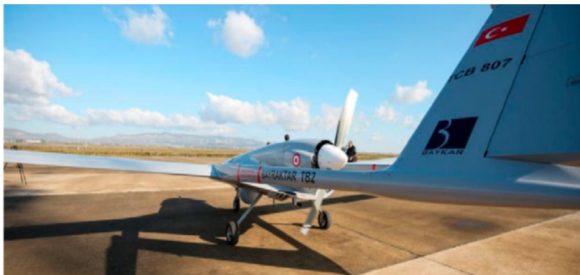
Imagen N°3: UAV Bayraktar TB2 desarrollado por Turquía y empleado para misiones de vigilancia, reconocimiento y apoyo a operaciones terrestres.
