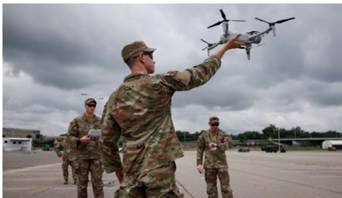
Imagen N°4: Mini UAV RQ-11 Raven en lanzamiento manual durante instrucción, realizada en 2020.
